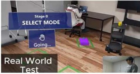
図 4.4 光学透過式 MR ビーコンを用いたロボット誘導操作手法
