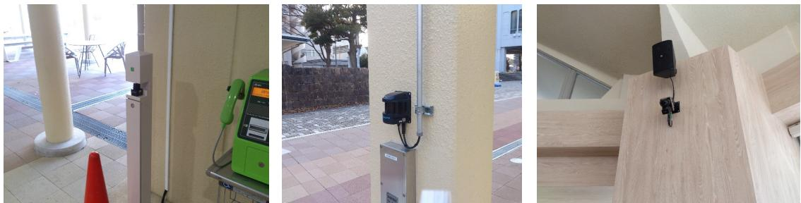
図 5.8: 左から屋内ポール型 2D センサ, 屋外型 2D センサ, 屋内型 3D センサ
