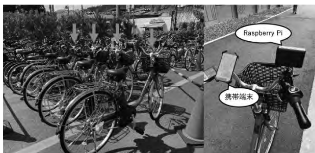
図 1：電動自転車に装備された携帯端末と RASPi
