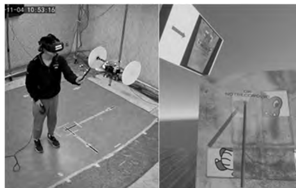
図 4.1 VR 環境におけるドローンのエンドエフェクタの回転による摩擦力提示デバイス
