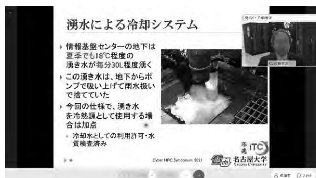
図 7：湧水による冷却システム
