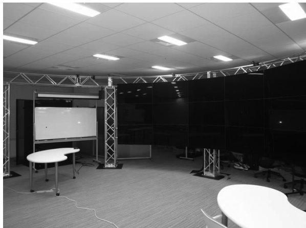
図 6 うめきた拠点に設置された 15 面シリンドリカル立体表示システム
