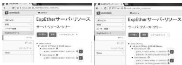
図 17 JOB～リソース管理連携動作（JOB の投入に連動して GPU が 2 個追加された）
