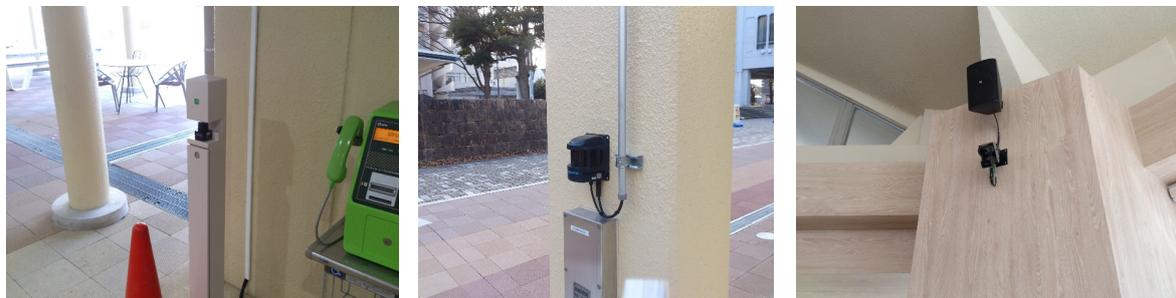
図 5.11: 左から屋内ボール型 2D センサ, 屋外型 2D センサ, 屋内型 3D センサ
