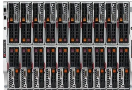
図4: 汎用 CPU ノードを収容する Blade Enclosure
