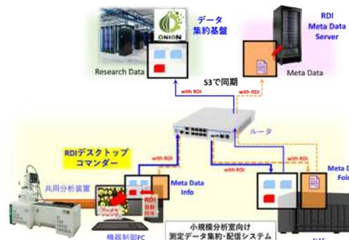
図 15 小規模分析室向け測定データ集約・配信システムにおけるメタデータ、固有識別子自動付与・流通システムコンセプト図
