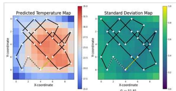
図 9. 環境計測ロボットの移動軌跡と推定結果
