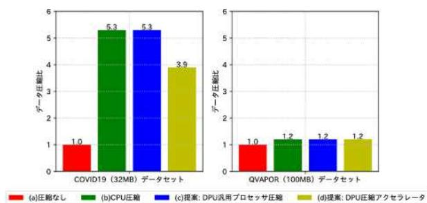
図 63: 圧縮処理によるデータ圧縮比
