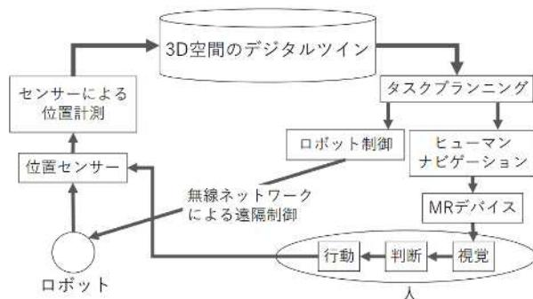
図 11. デジタルツインを用いたヒューマンロボットコラボレーションシステムの全体像
