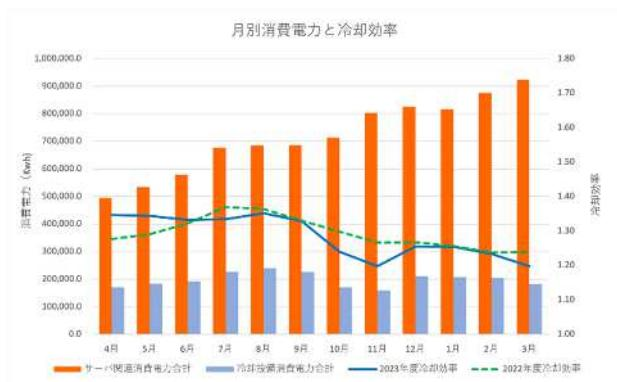
図 2 2023 年度月別サーバ・冷却設備の消費電力と冷却効率
