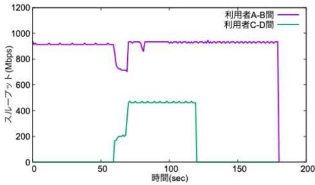
図 4 提案手法を用いた通信のスループット
