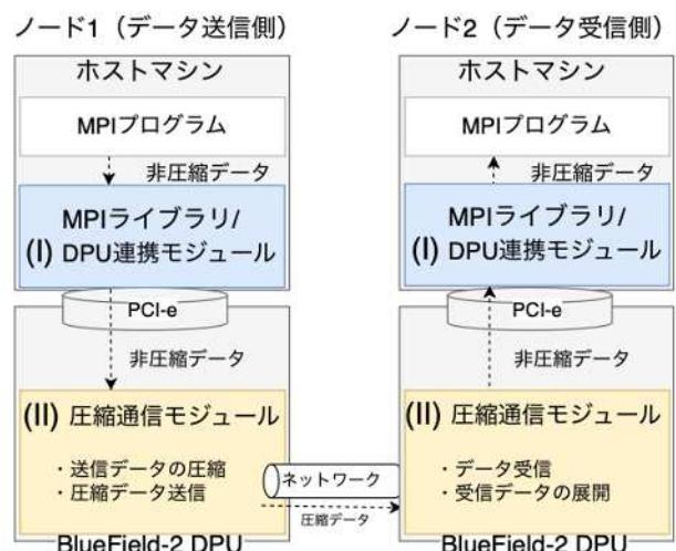
図 62: 提案モジュールによるデータ圧縮通信
