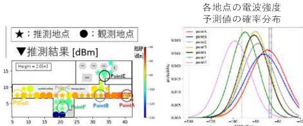
図 5. ミリ波無線通信環境の確率的な推測結果
