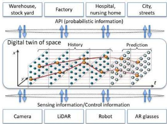
図 3. 確率的デジタルツインの概要
