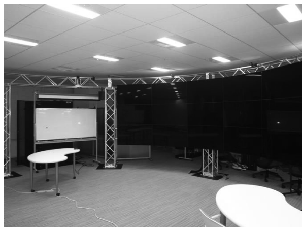
図 33 うめきた拠点に設置された 15 面シリンドリカル立体表示システム
